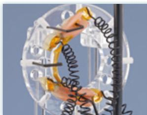
*Prothese mit Federkontakten befestigt*
